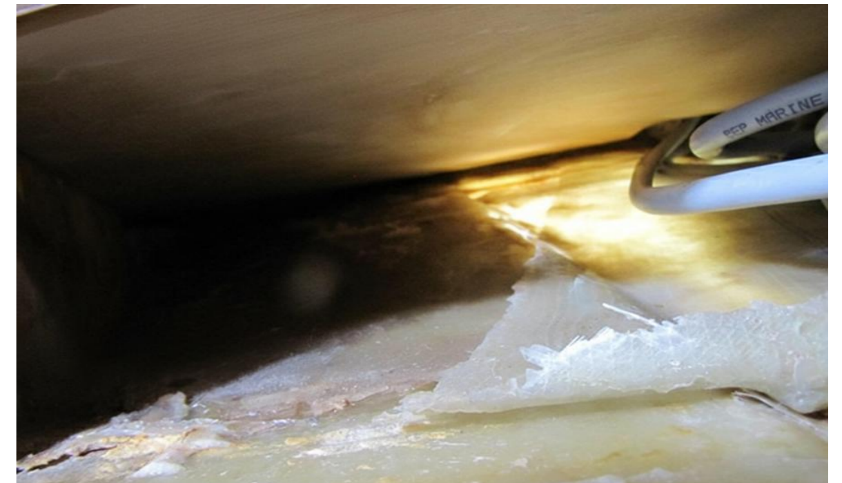
Figura 1. Delaminación de la fibra de vidrio en Ferry «Dream Weaver».
