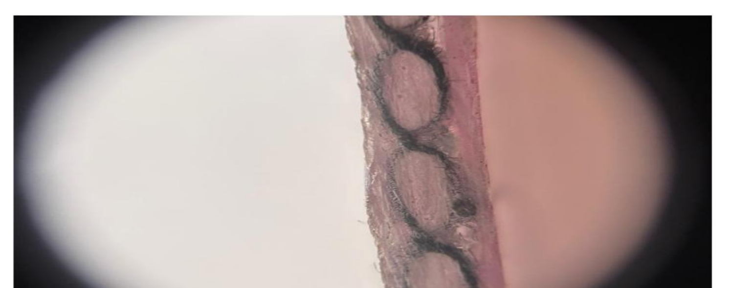
Figura 5. Vista maximizada de las puntadas de fibras de aramida en las probetas.
