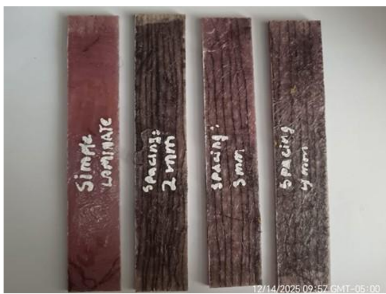
Figura 2. Elaboración de especímenes a ensayar por ensayos destructivos
