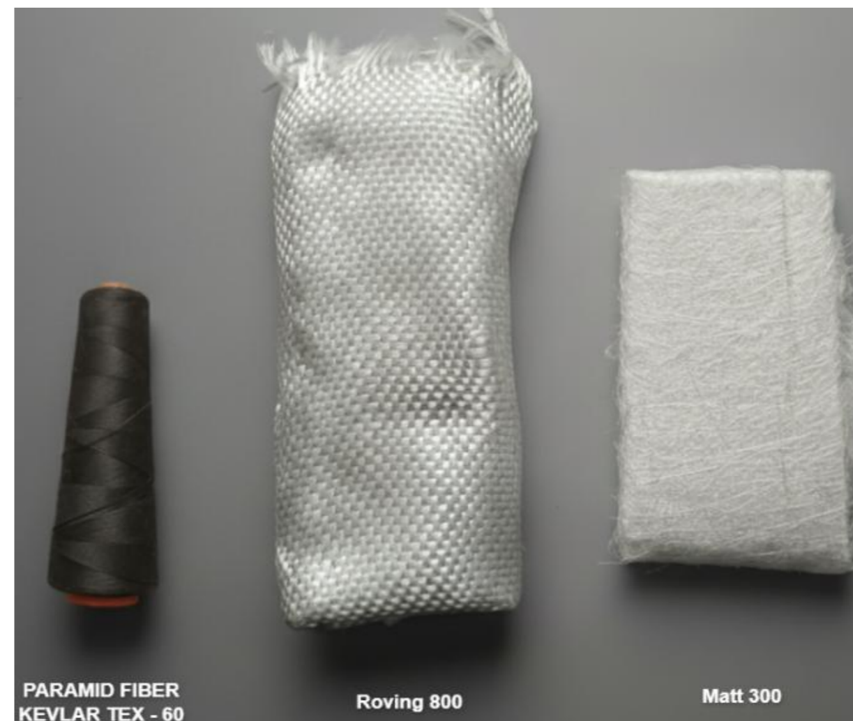
Figura 3. Materia prima utilizada en el laminado de Fibra de vidrio
