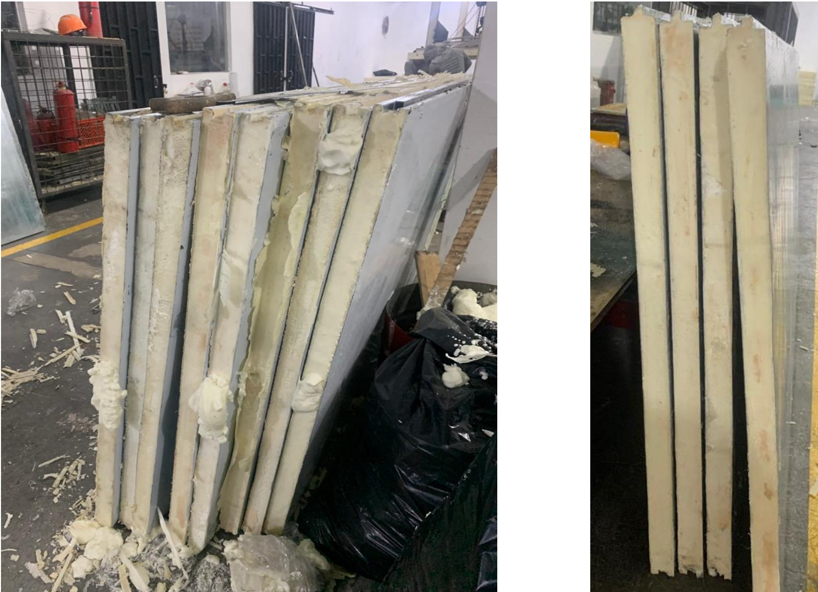
Figura 1. – Planchas de poliuretano con excedentes y residuos a los lados (izq). Planchas limpias tras remover excedentes (der).
