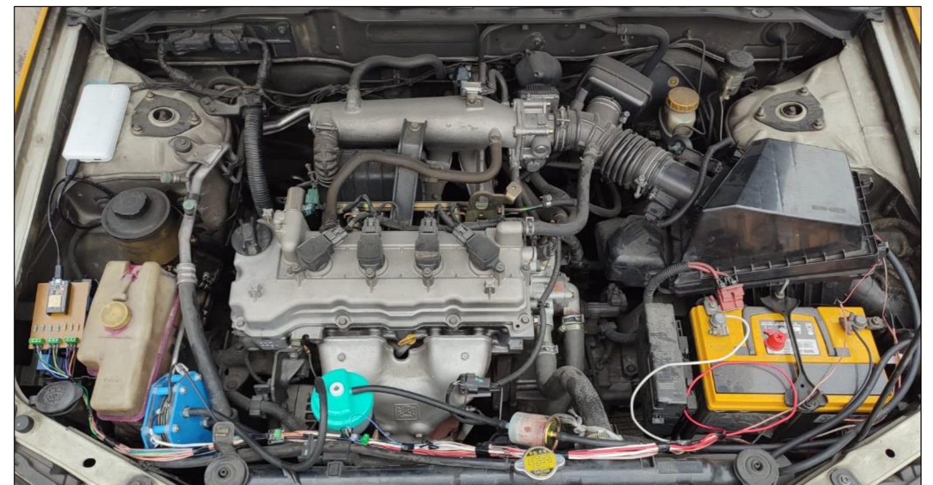
Figura 4. Sistema IoT de generación de hidrógeno desplegado dentro de un vehículo
