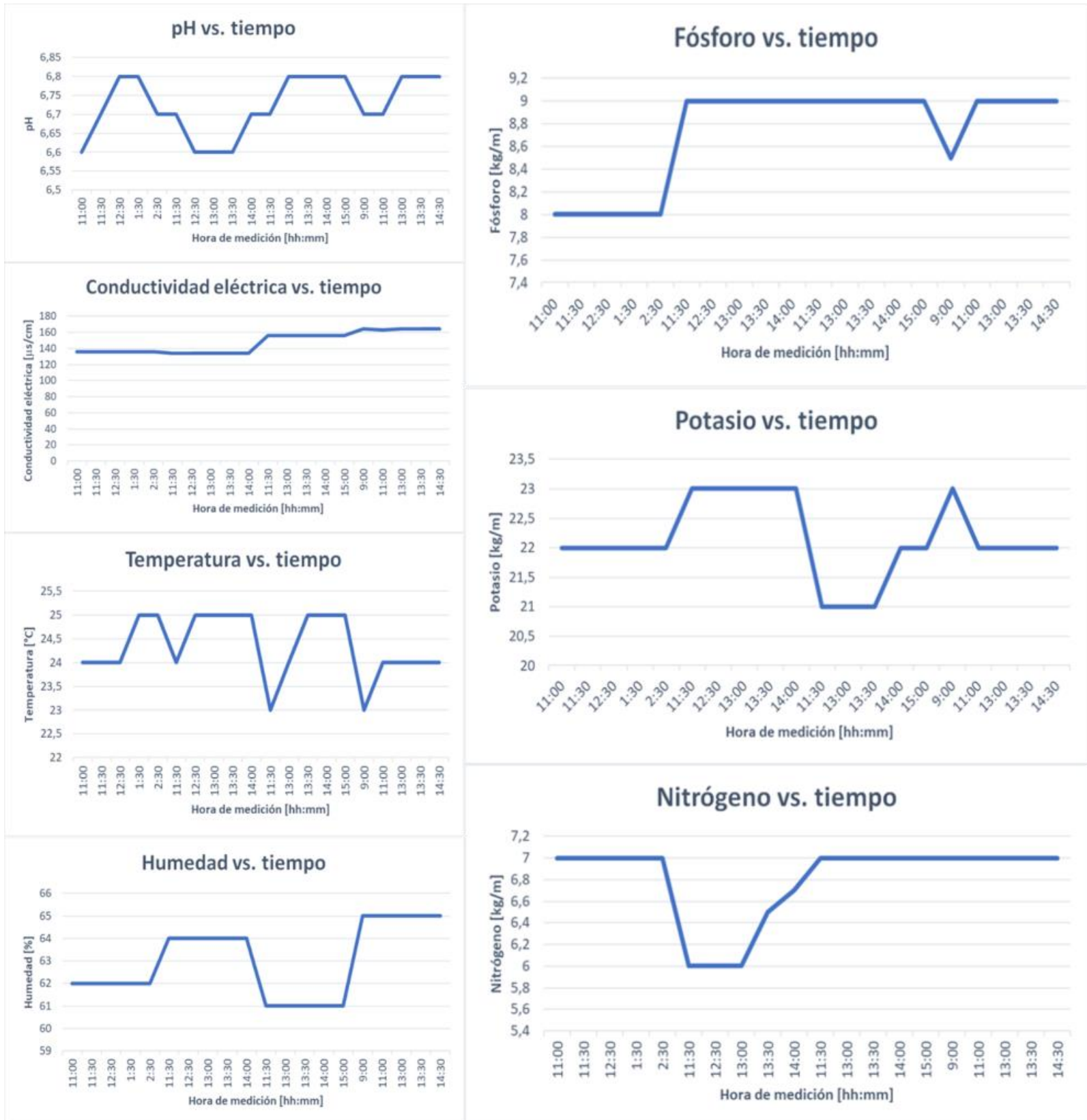
Imagen 4. Gráficas de dispersión de los parámetros de temperatura, humedad, conductividad eléctrica, pH y los nutrientes NPK vs. tiempo
