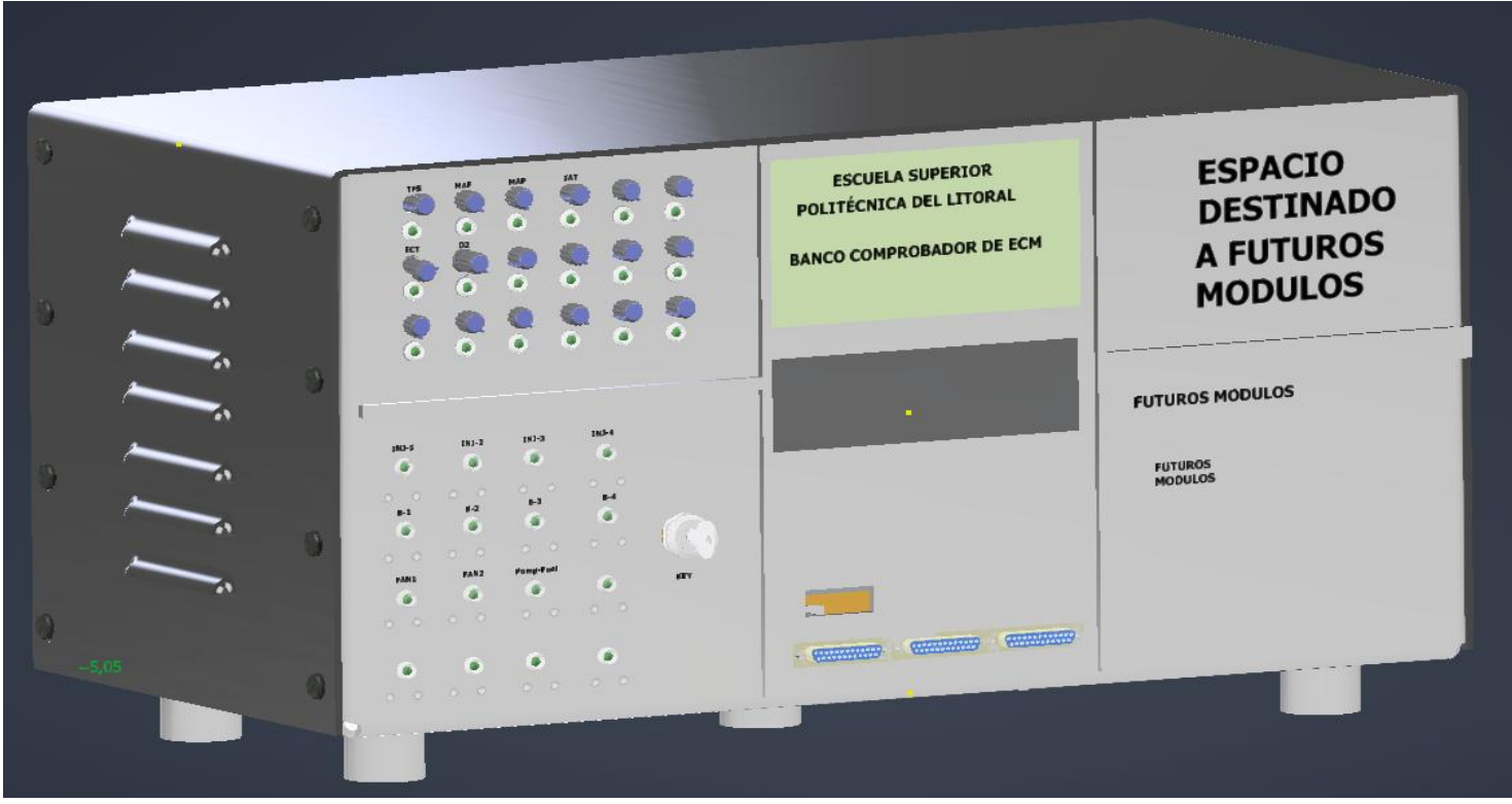
Figura 5: Prototipo físico del banco de pruebas desarrollado.
