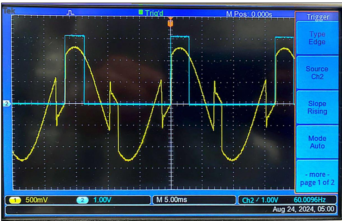
c) Medición de voltaje a la salida del convertidor.
