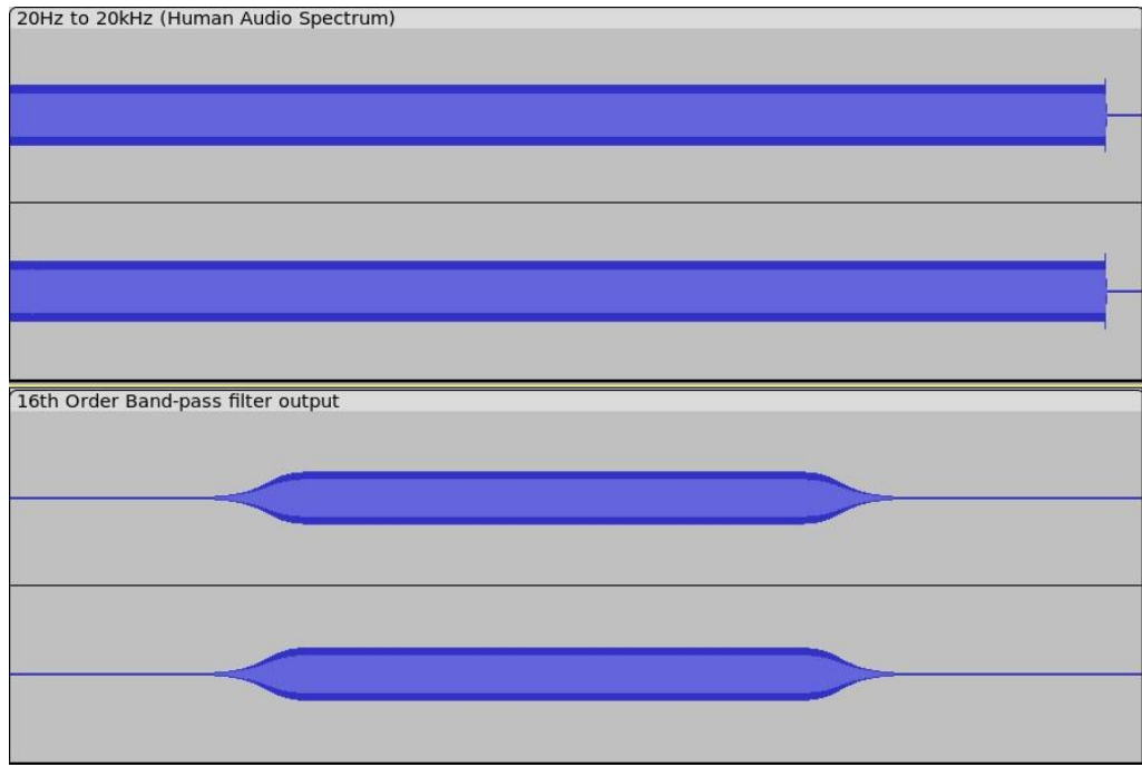
Funcionamiento del filtro pasa-banda dentro del espectro audible
