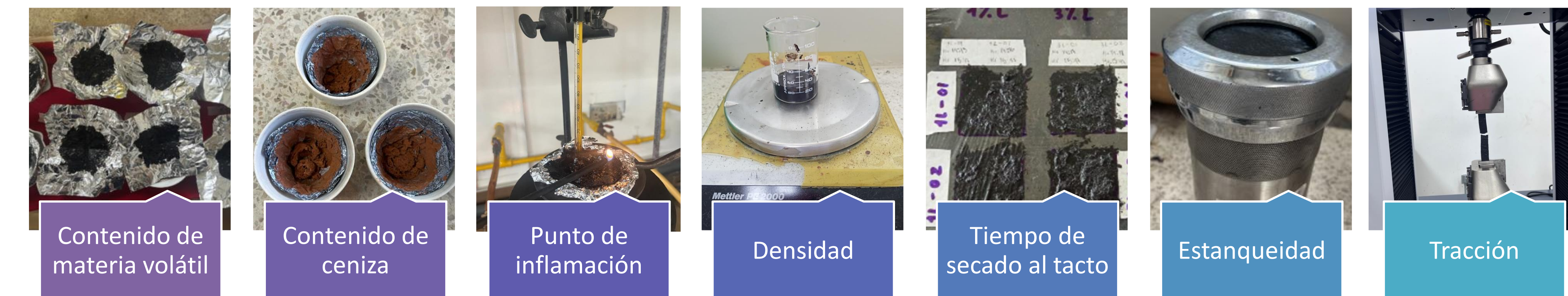
Fig 4. Diagrama de ensayos propuestos
