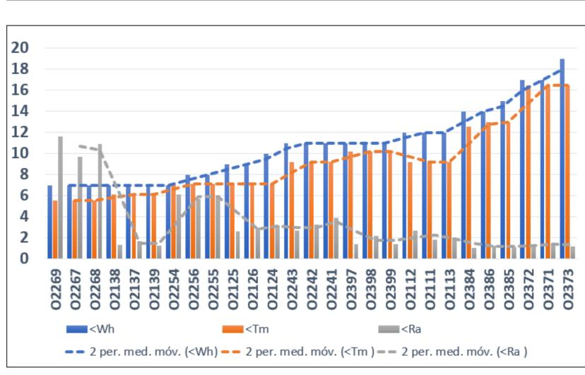
La probeta con los mejores valores de rugosidad, tiempo de mecanizado y consumo energético combinados fue obtenida con la estrategia de corte en espiral (1.257μm, 6.13 min y 7 Wh) con 15000 RPM y 2700 mm/min. Sin embargo, sí se desean obtener los mejores valores de calidad superficial se encuentran en la probeta de la estrategia de corte en un sentido con 1.099μm, 12.57 min y 14Wh a 10800RPM y 2100 mm/min.
