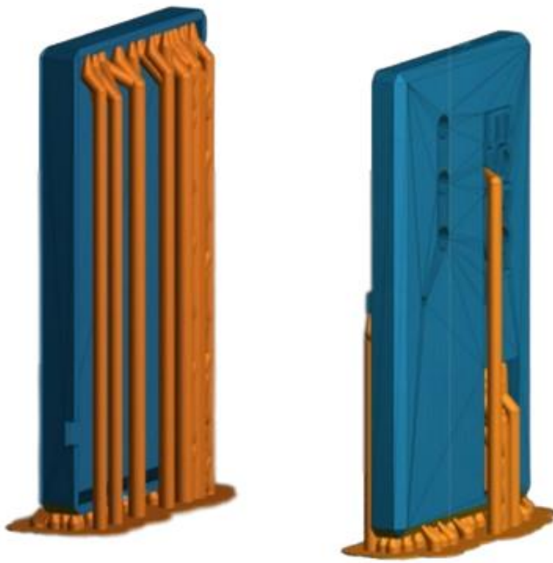
Configuración de soportes para impresión 3D.
