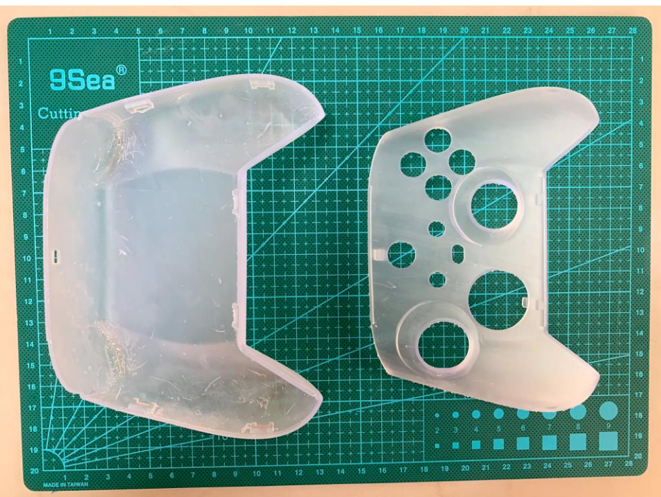
Resultados de impresión 3D de las piezas de la carcasa fabricadas con la tecnología SLA de la impresora Forms 2
