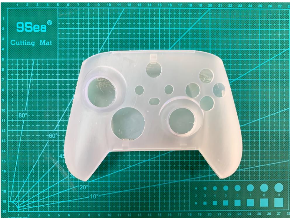
Resultados de impresión 3D de las piezas de la carcasa fabricadas con la tecnología SLA de la impresora Forms 2
