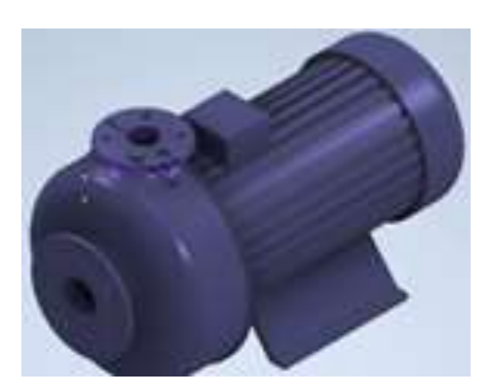
Figura 6. Selección de bomba centrífuga de potencia 0,41kW, caudal de 5,5m 3 /h, altura de 15 metros y eficiencia del 55%
