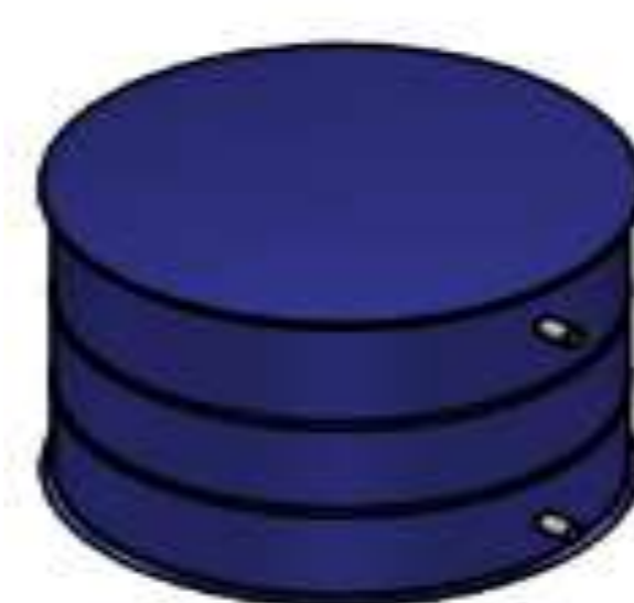
Figura 5. Diseño del reservorio superior según código ASME. Presión de trabajo de hasta 506,3 psi o 356 metros de altura. Capacidad de 500 litros.
