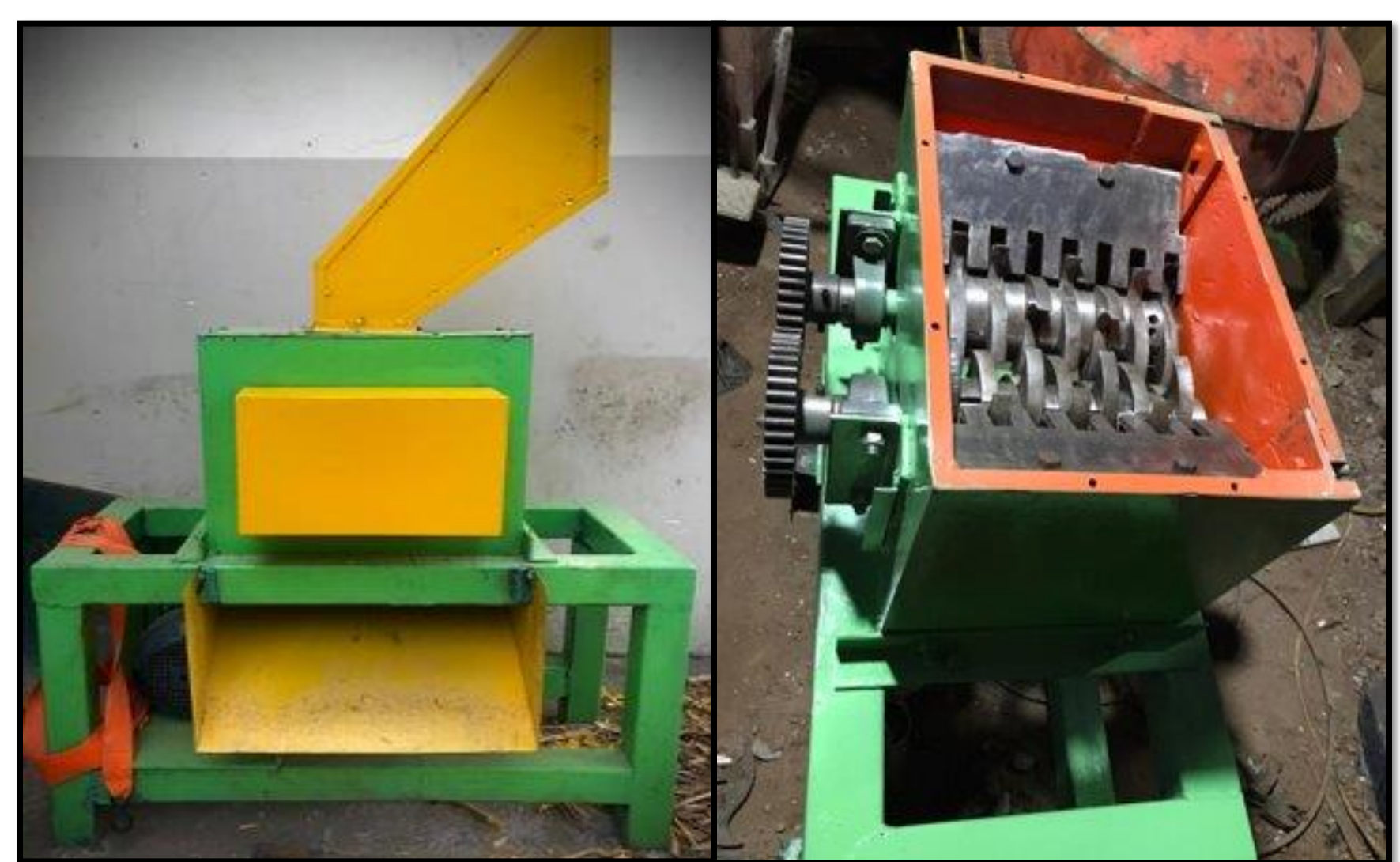
Imagen 1. Máquina troceadora de residuos lignocelulósicos
