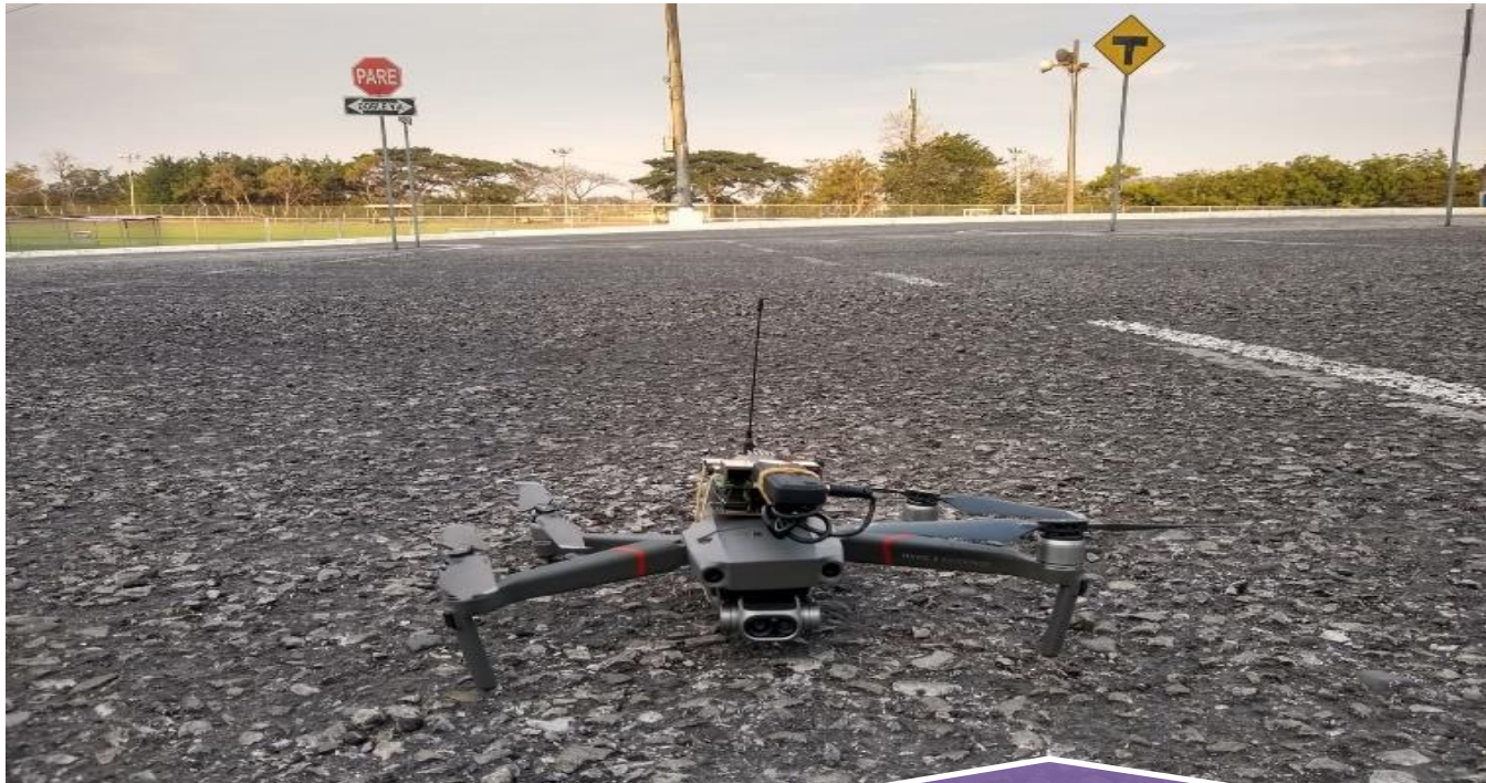
Ilustración 3. Implementación de un Analizador Espectral en un dron
