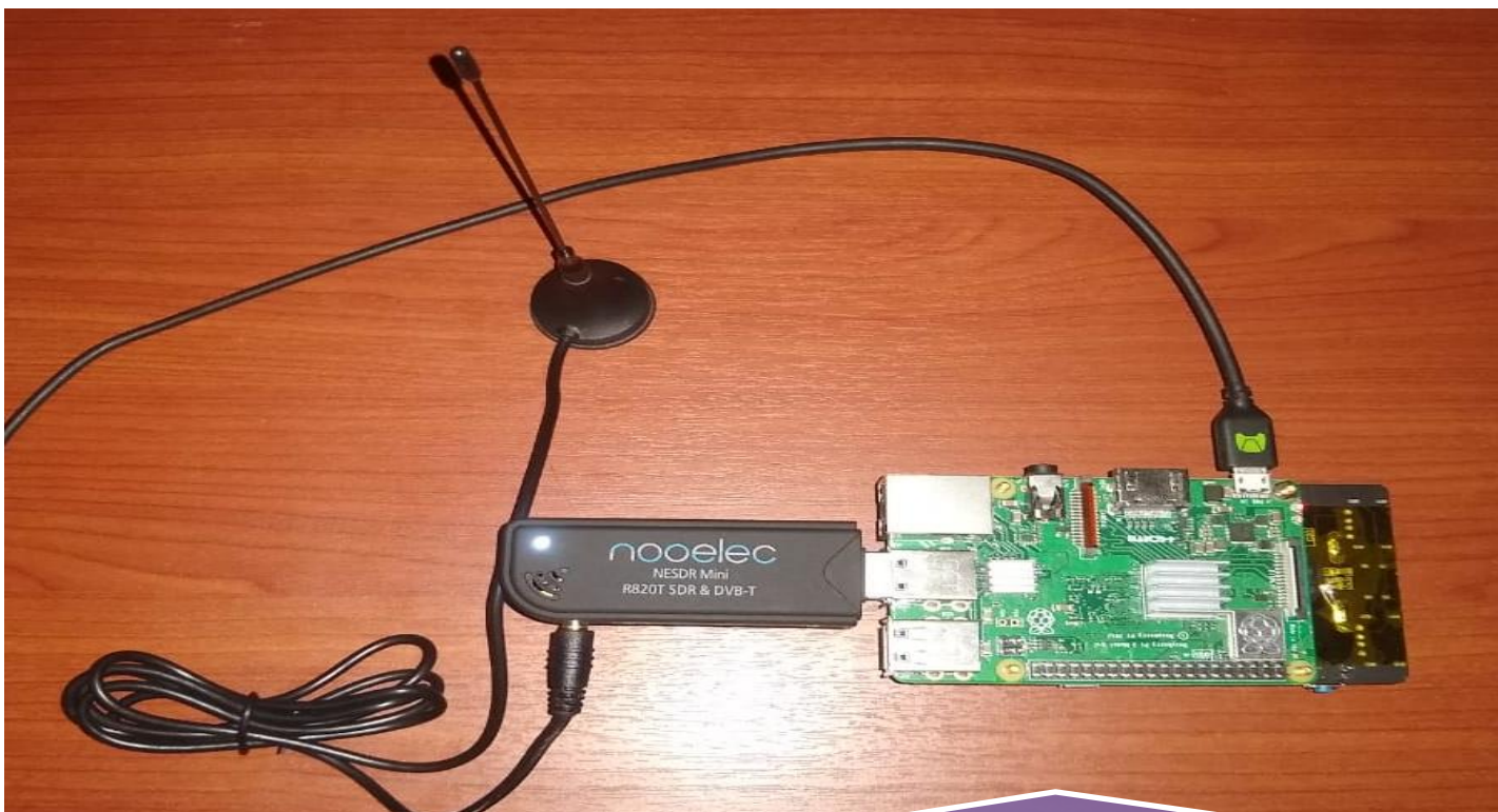
Ilustración 2. Analizador Espectral implementado en una Raspberry Pi
