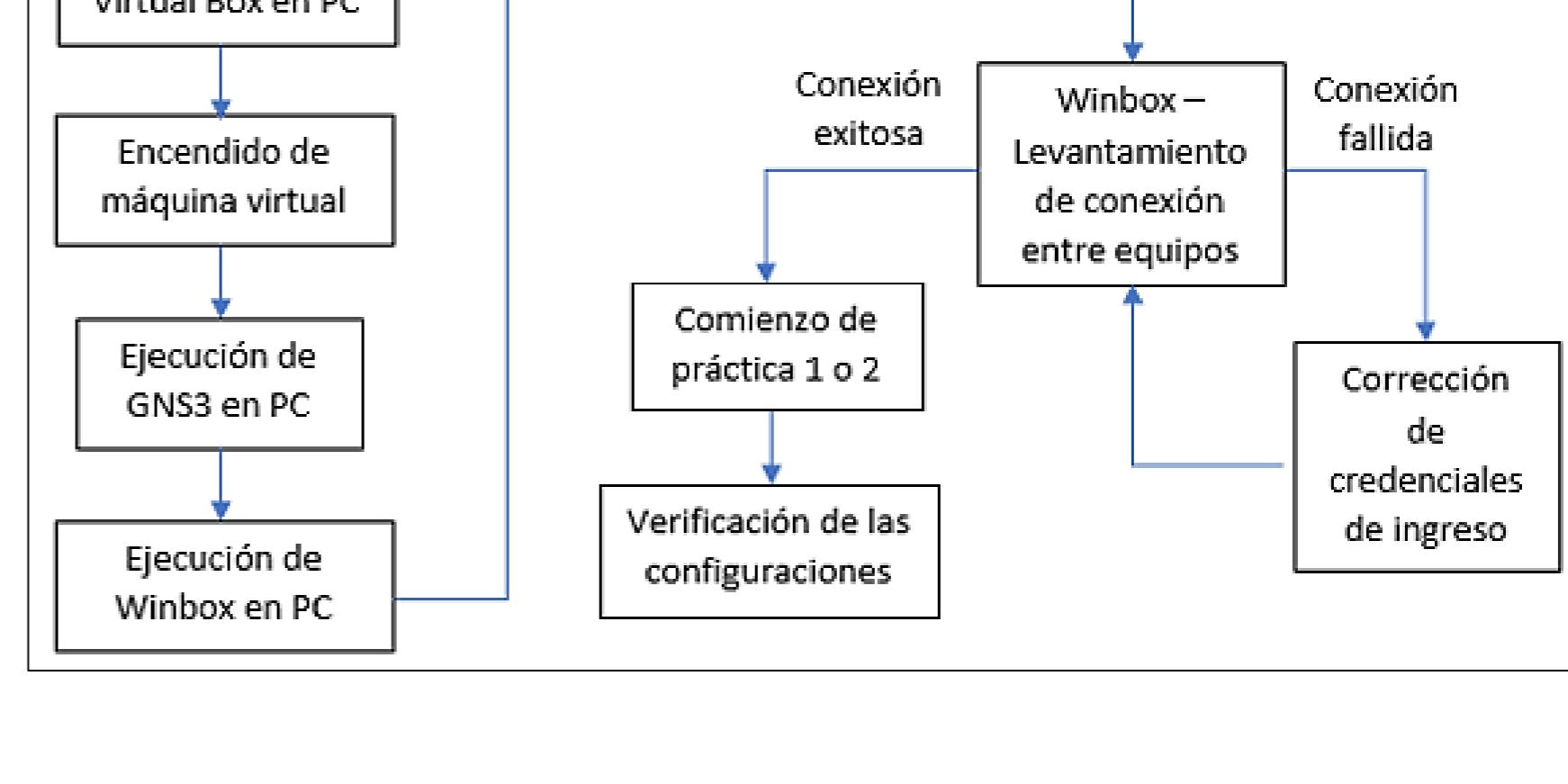
En base a ello, se creó una máquina virtual mediante la plataforma VM Ware, donde se diseñó la topología y conexiones de los equipos virtuales MikroTik de la práctica. Mediante la herramienta Winbox, se realizó las configuraciones manuales de las direcciones IP y protocolo RIP.
