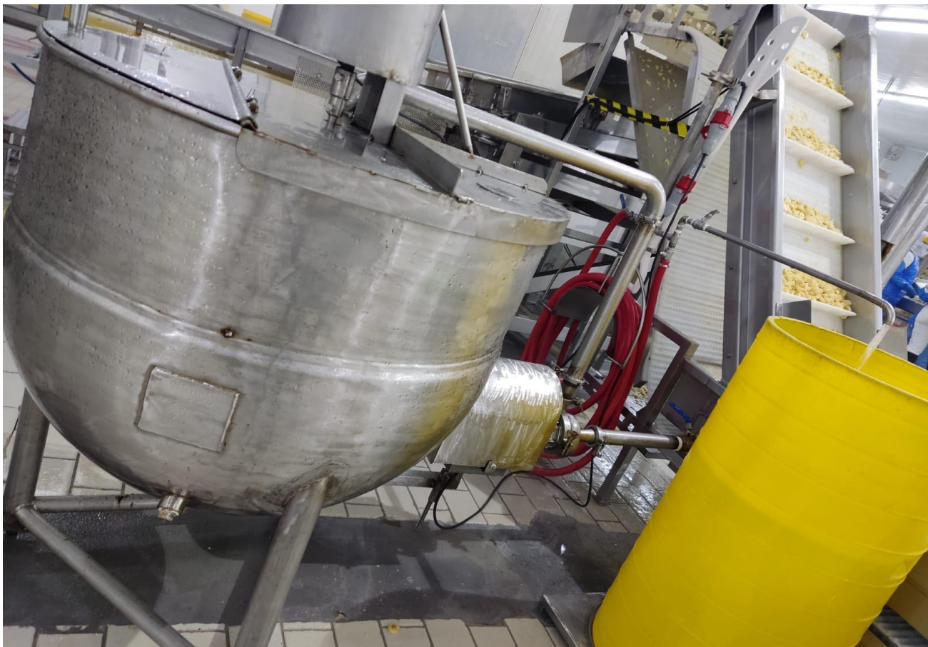
Figura 3.- Reactor a escala piloto
