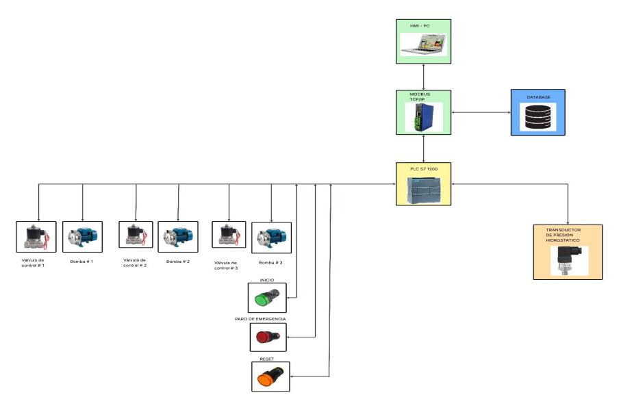
Se propuso como solución el diseño de un tanque cilíndrico-cono, controlado por un PLC SIEMENS S7-1200 capaz de accionar de forma secuencial el ingreso a la dosificación de los líquidos, mientras que el monitoreo, será implementado NODE RED, capaz de accionar y mostrar un dashboard sencillo al uso del operador.
