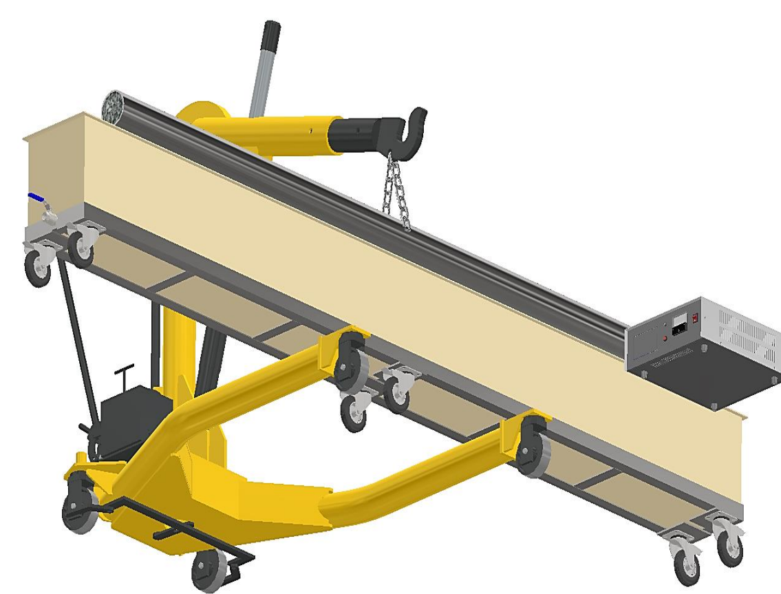
Figura 6. Base estructural con tres pares de garruchas de 5'' para soporte del tanque de inmersión y su contenido
