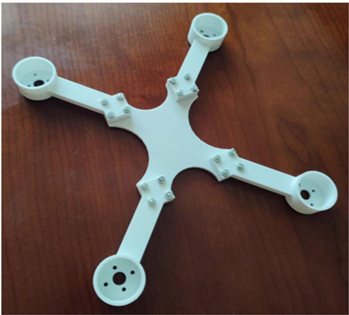
Figura 6 Diseño de dron impreso en material PLA
