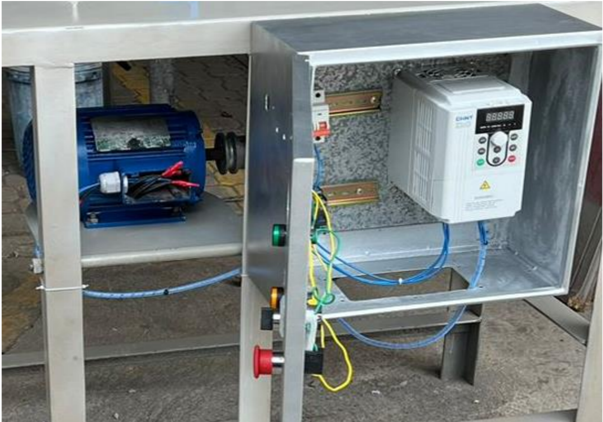
Figura 7 – Variador de frecuencia conectado al motor de 2 HP
