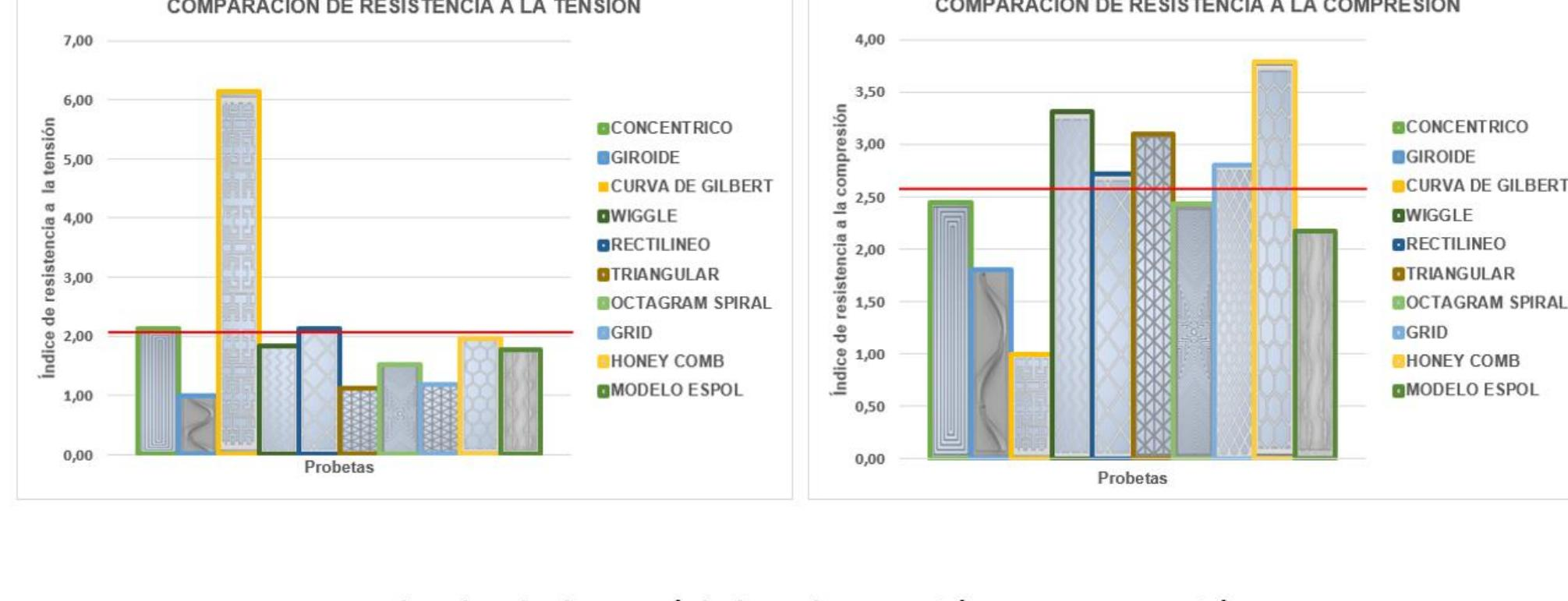
Resultado de los módulos de tensión y compresión en dirección paralela al plano del boceto del patrón de relleno
