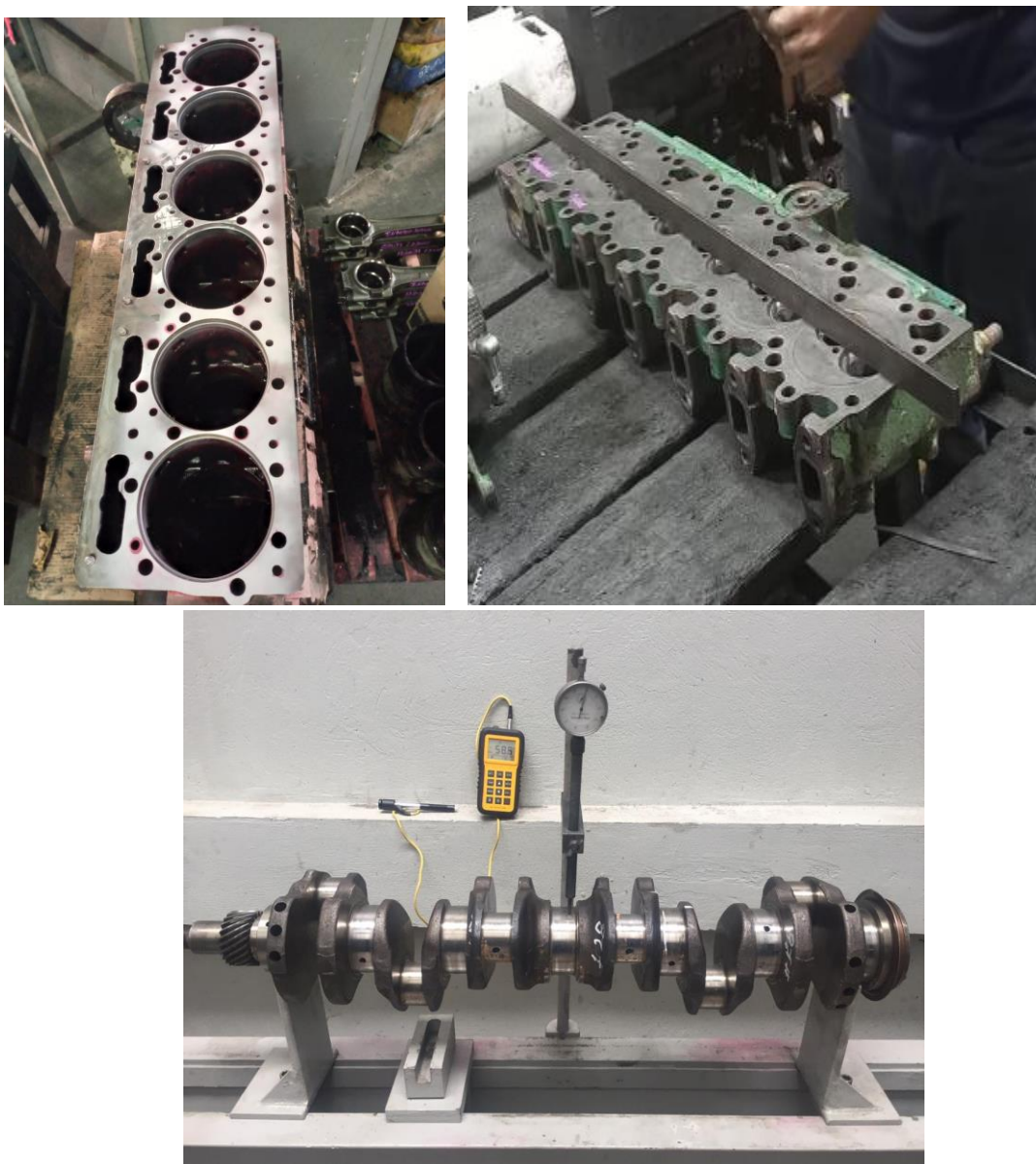
Reacondicionamiento de componentes de motor DOOSAN PU126TI
