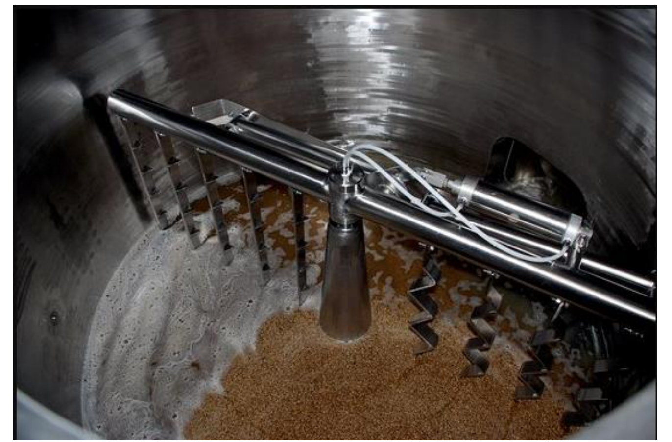
Interior de cuba filtro
