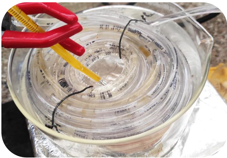
Reactor tubular espiral de 10 m de largo en baño María
