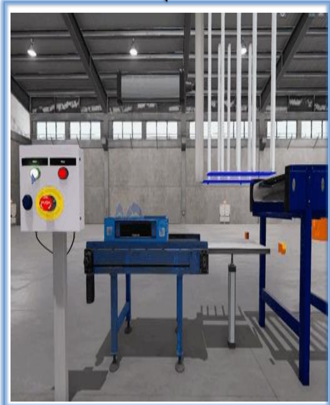
Simulación del prototipo de la máquina apiladora de gavetas.
