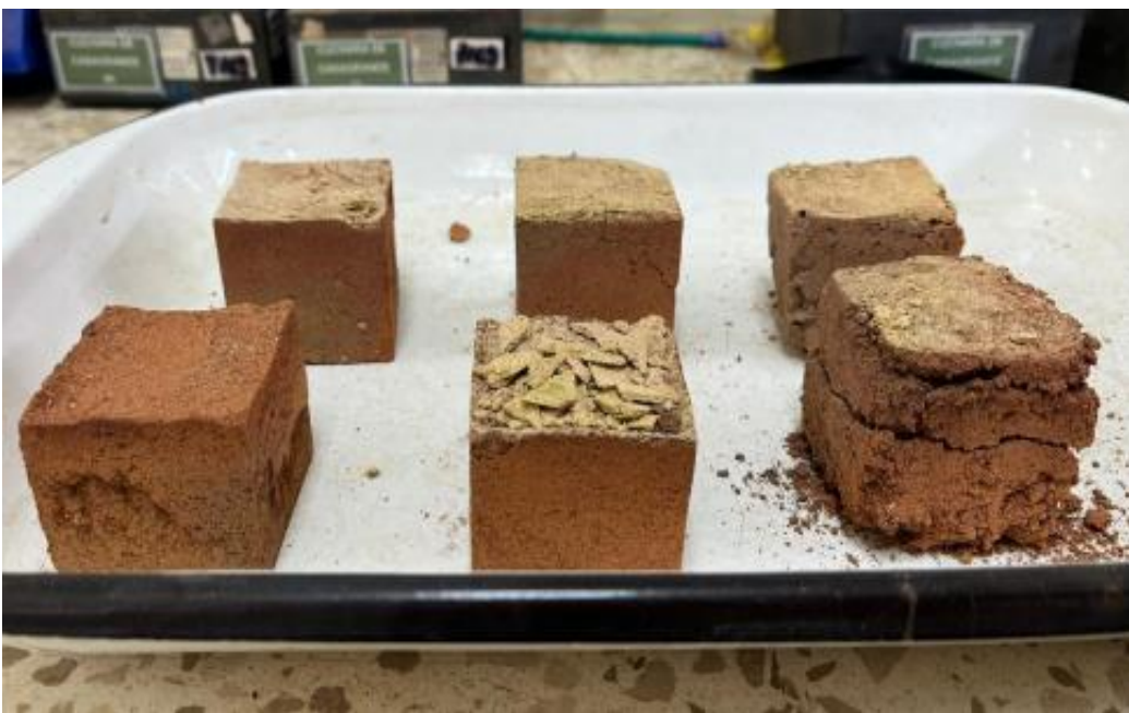
Ilustración 5: Bloques de arcilla cocidos a altas temperaturas con diferentes composiciones de lodo
