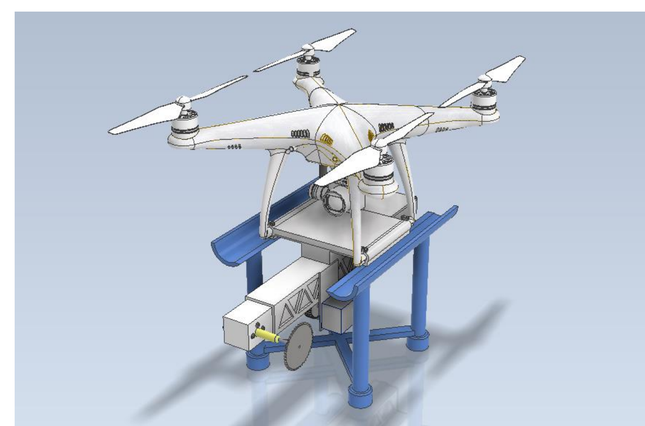
Figura 5. Dron en la estación base de despegue
