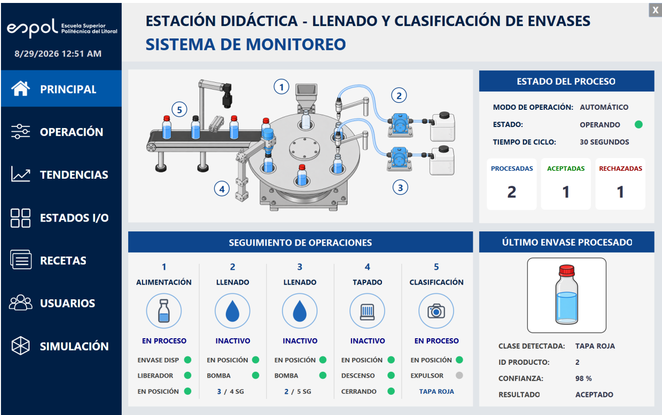
Figura 5. Sistema SCADA de la estación didáctica
