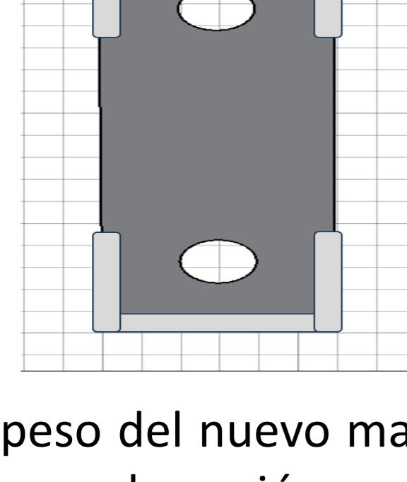
Además a los martillos se les añadiría un recubrimiento de soldadura UTP LEDURIT 65 en sus extremos, dicha soldadura posee propiedades anti abrasivas y una dureza de aproximadamente 600 HB.
