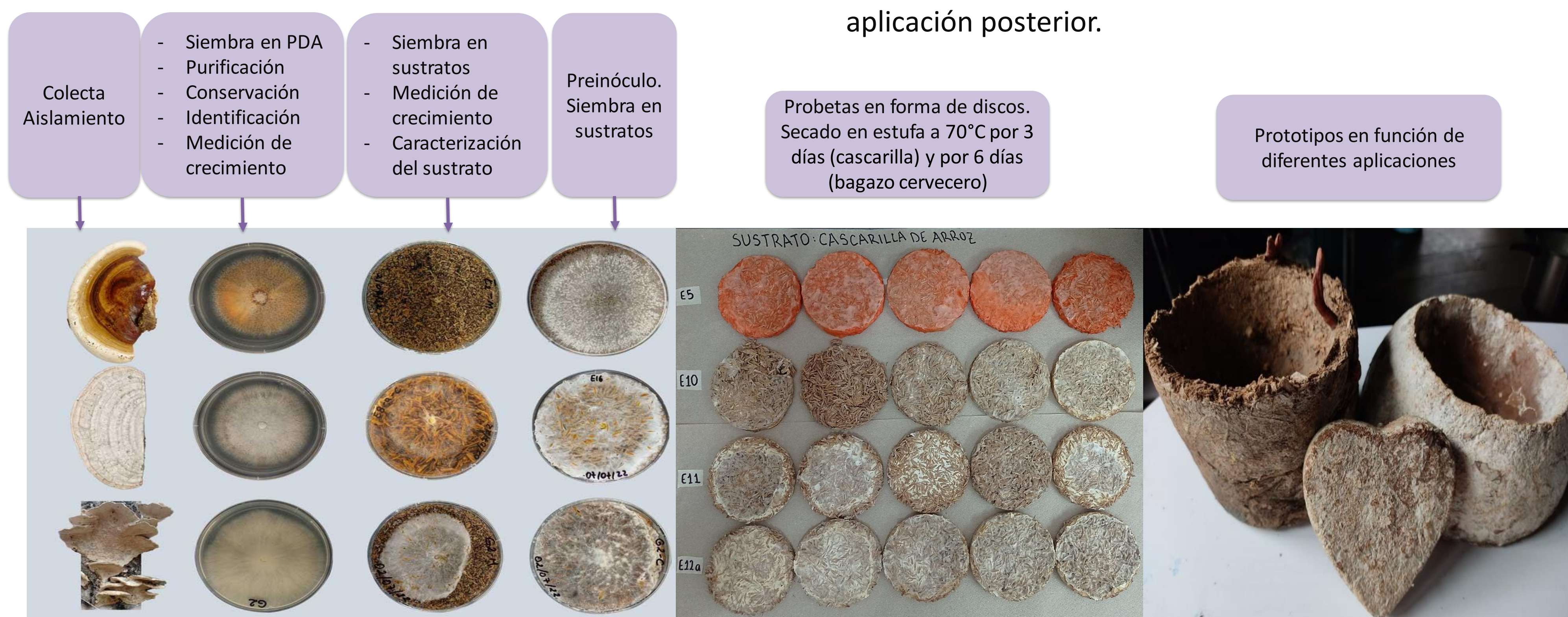
Figura 2.- Esquema del procedimiento para la generación de probetas y prototipos de micelio y residuos como sustratos.
