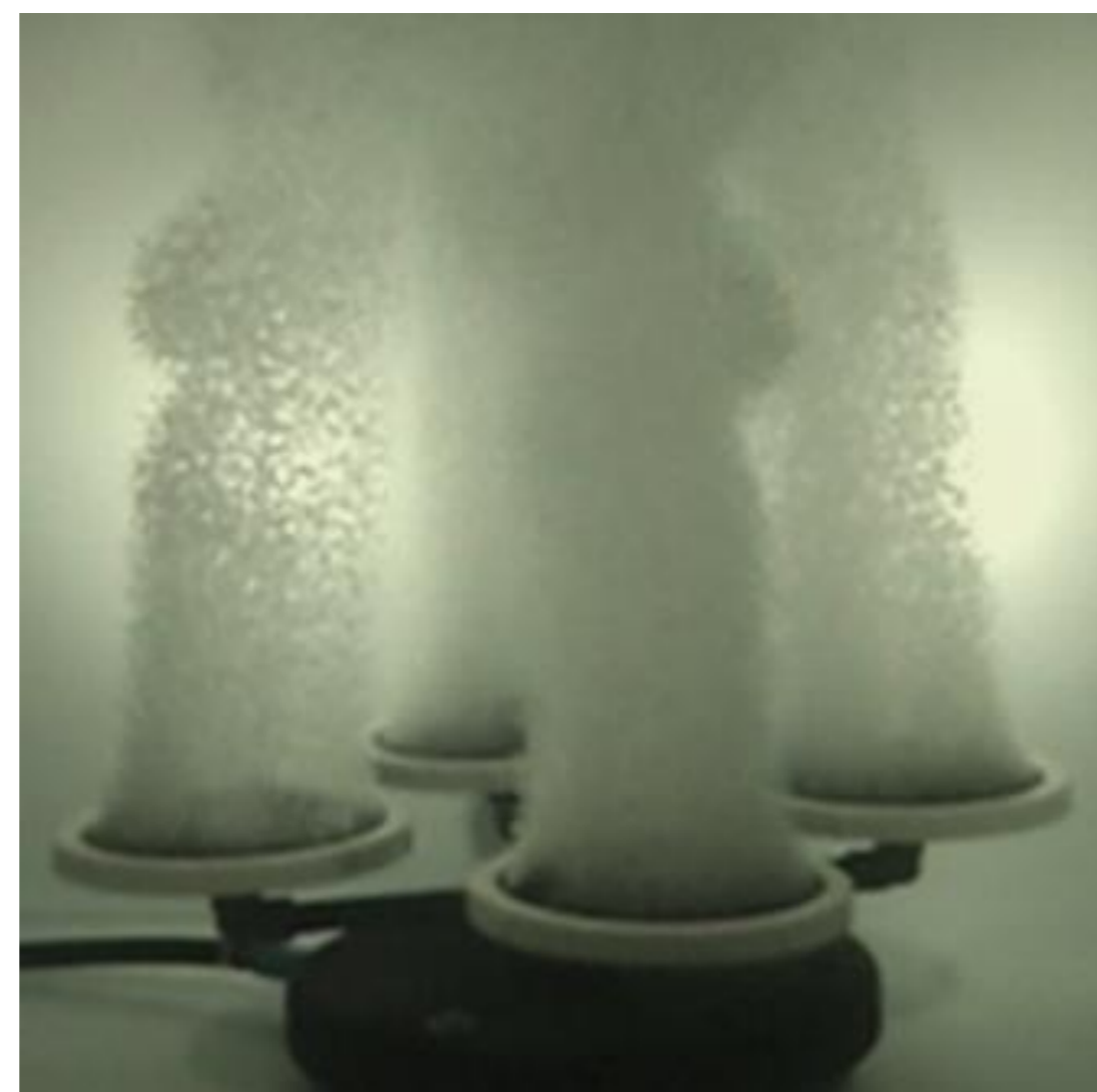
Gráfico 3. Funcionamiento típico del difusor.
