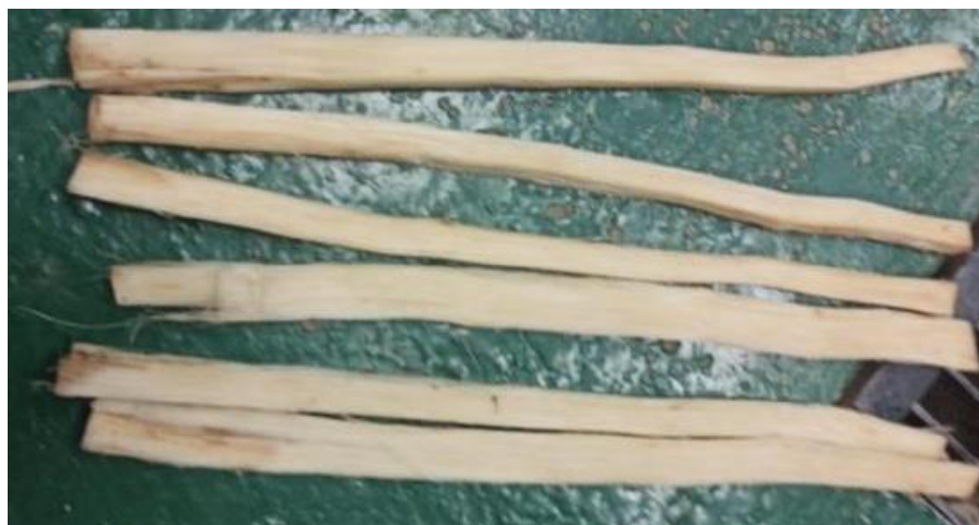
Figura 4: Fibra extraída del raquis lista para el remojo
