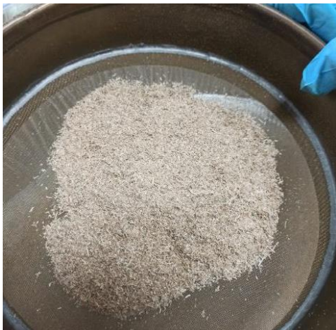
Figura 6: Fibra molida y en proceso de tamizado
