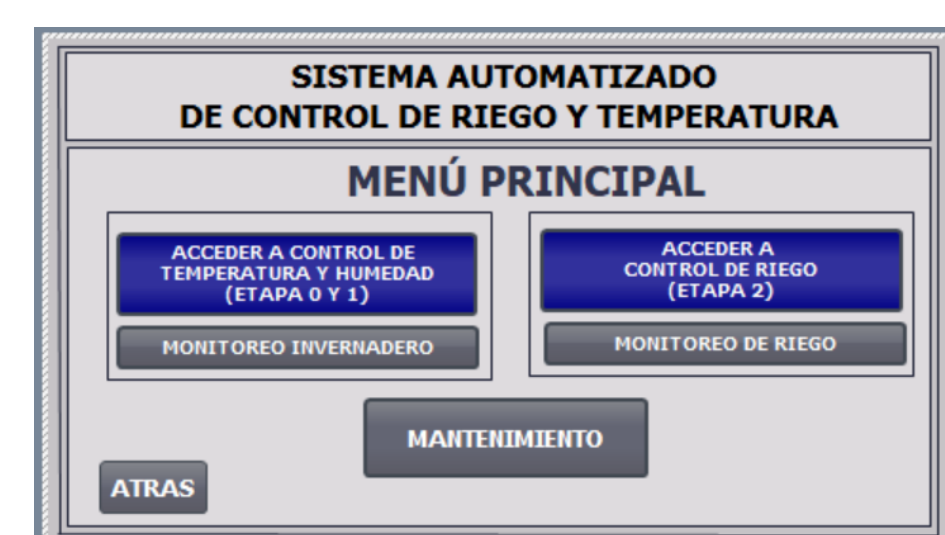
Pantalla principal del HMI para el control de riego y temperatura
