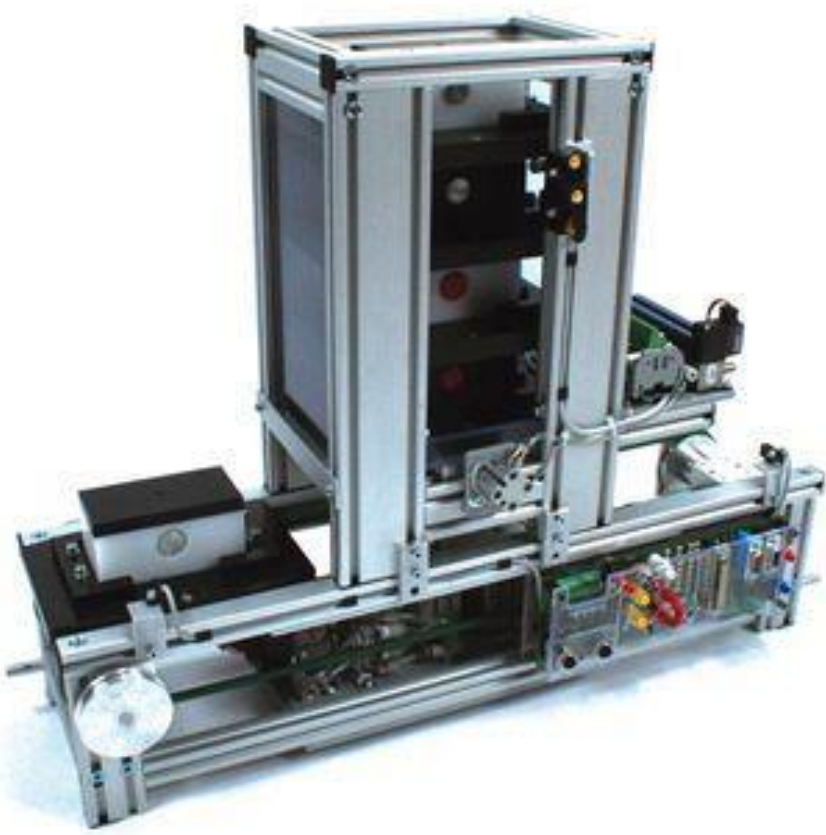
Figura 5. Estación de almacenamiento intermedio IMS10.
