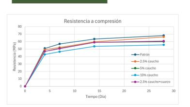
Porcentajes de 2.5%, 5%, 10% de caucho y 2.5% caucho + cuarzo. Para que no se pierda la resistencia, se escogió adicionar arena de cuarzo a la prueba de 5% de caucho.
