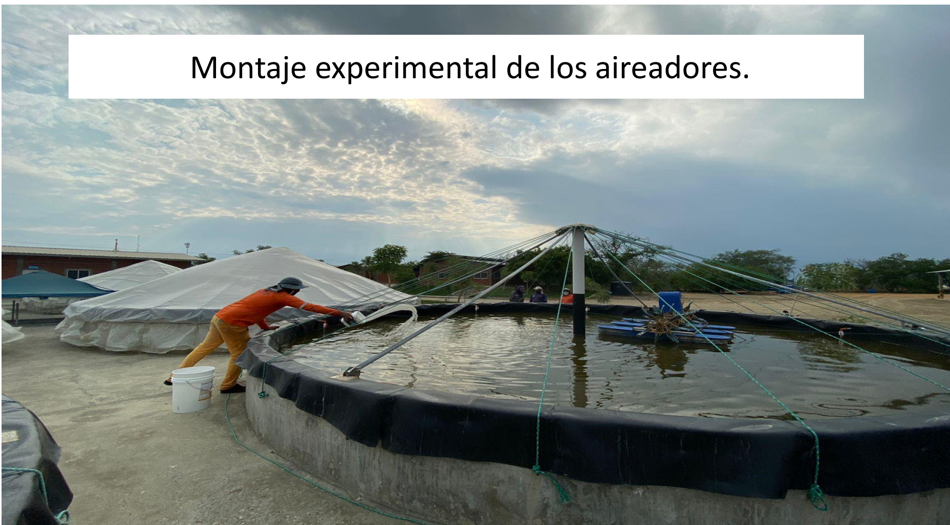
Aireación con equipos modelo de paleta en piscina de camarón Penaeus vannamei
