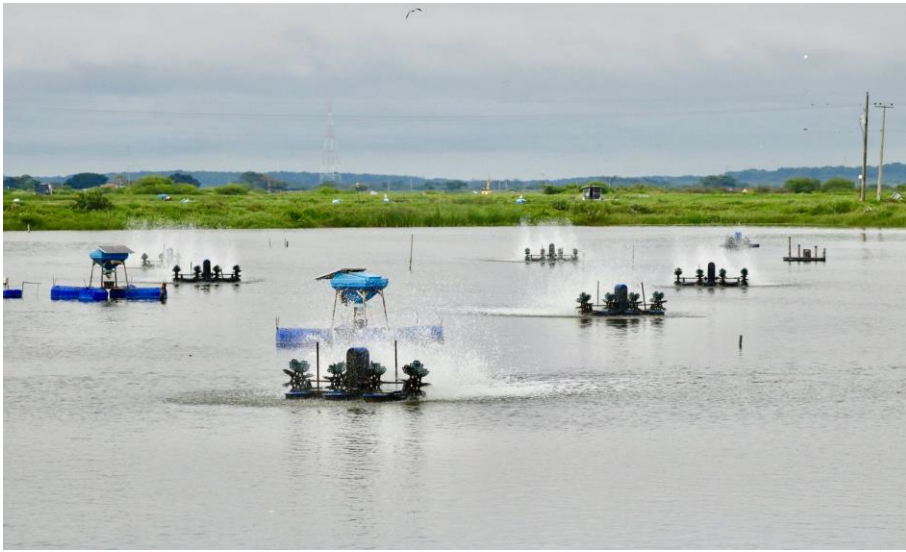
Aireación con equipos modelo de paleta en piscina de camarón Penaeus vannamei
