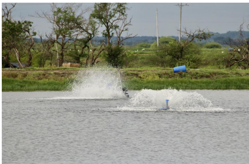
Aireación con equipos modelo Splash en piscina de camarón Penaeus vannamei .
