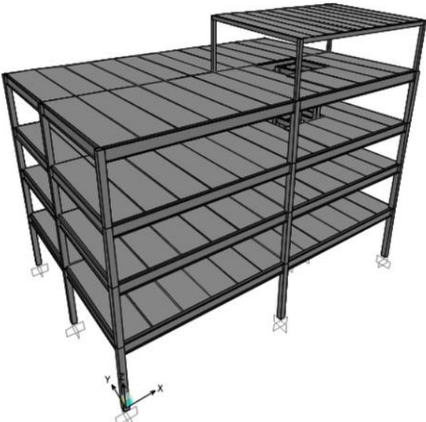
Figura 2. Propuesta de diseño en Acero Estructural.
