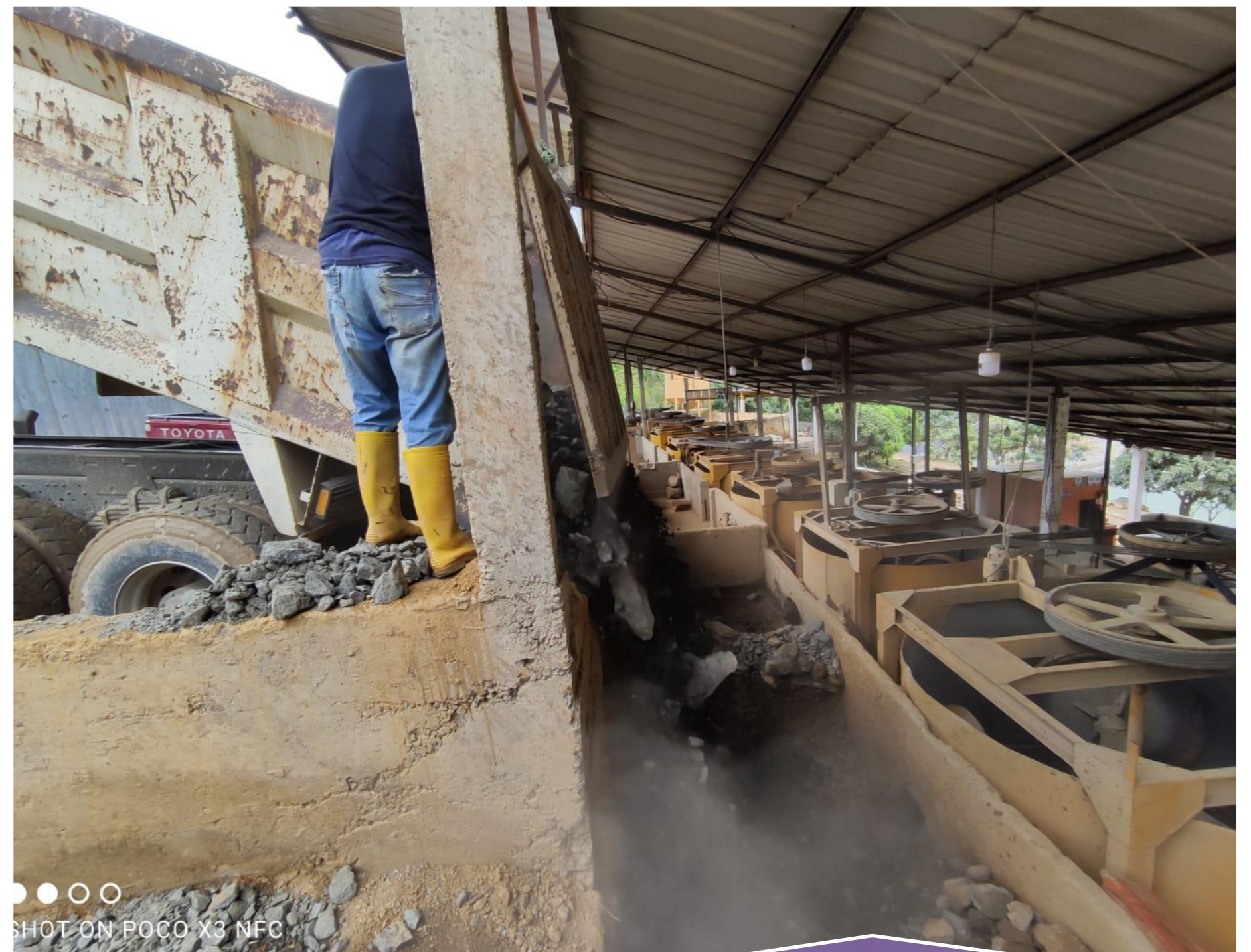
Material sin trituración entrando a la zona de alimentación de los molinos tipo chileno.
