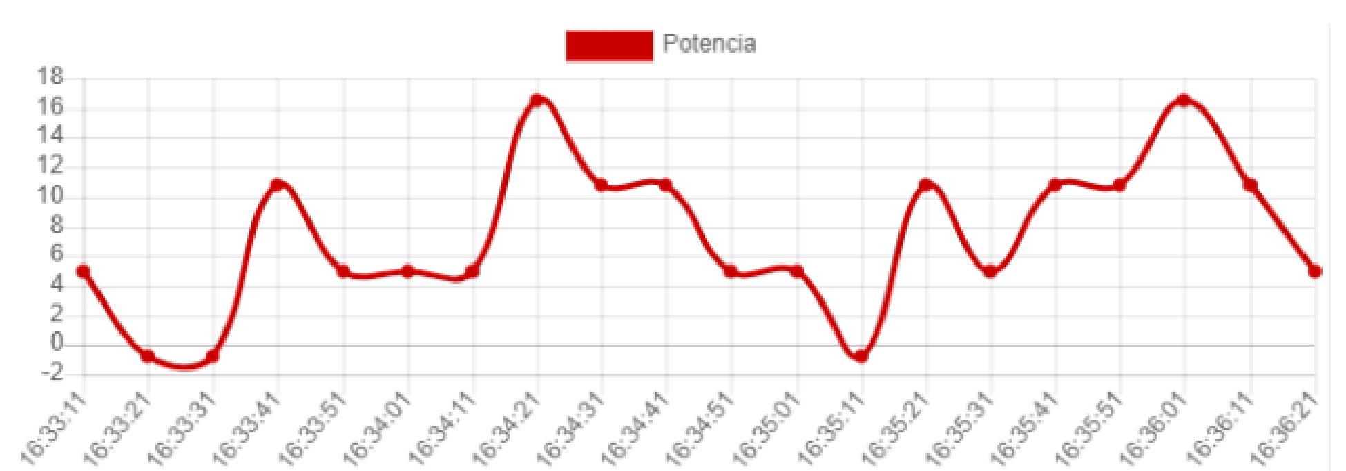
Figura 4.-Gráfica de consumo de potencia en modo ON
