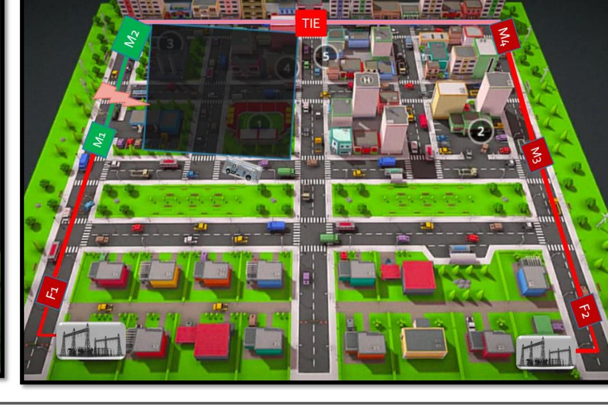
Estos escenarios establecen accionamientos por parte de los dispositivos electrónicos inteligentes, los cuales son enviados a los reconnectadores, para que estos realicen las reconexiones y reconfiguraciones del sistema, ante una falla permanente o sostenida. Este comportamiento junto a los niveles de voltaje, corriente, y potencia, se pueden observar en tiempo real, a través de la interfaz del HMI del sistema SCADA, tal como lo haría el operador del sistema.
