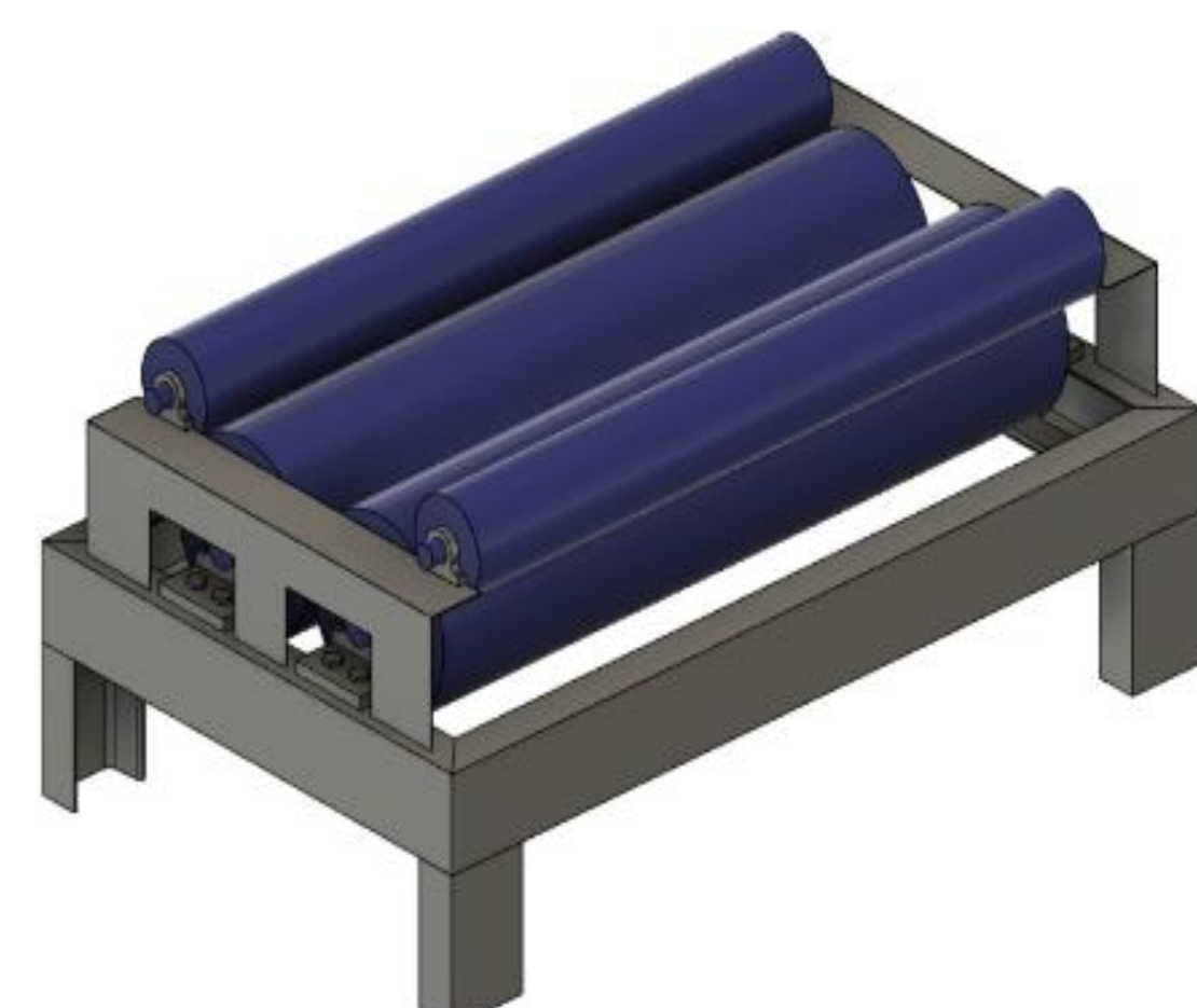
Estructura para los rodillos niveladores de tensión de la lámina de acero
